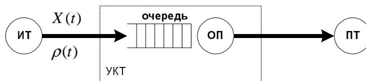
Рис. 2.1. Функциональная схема коммутатора в терминах СМО
